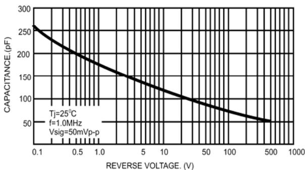
FIG.5- TYPICAL REVERSE CHARACTERISTICS PER LEG
